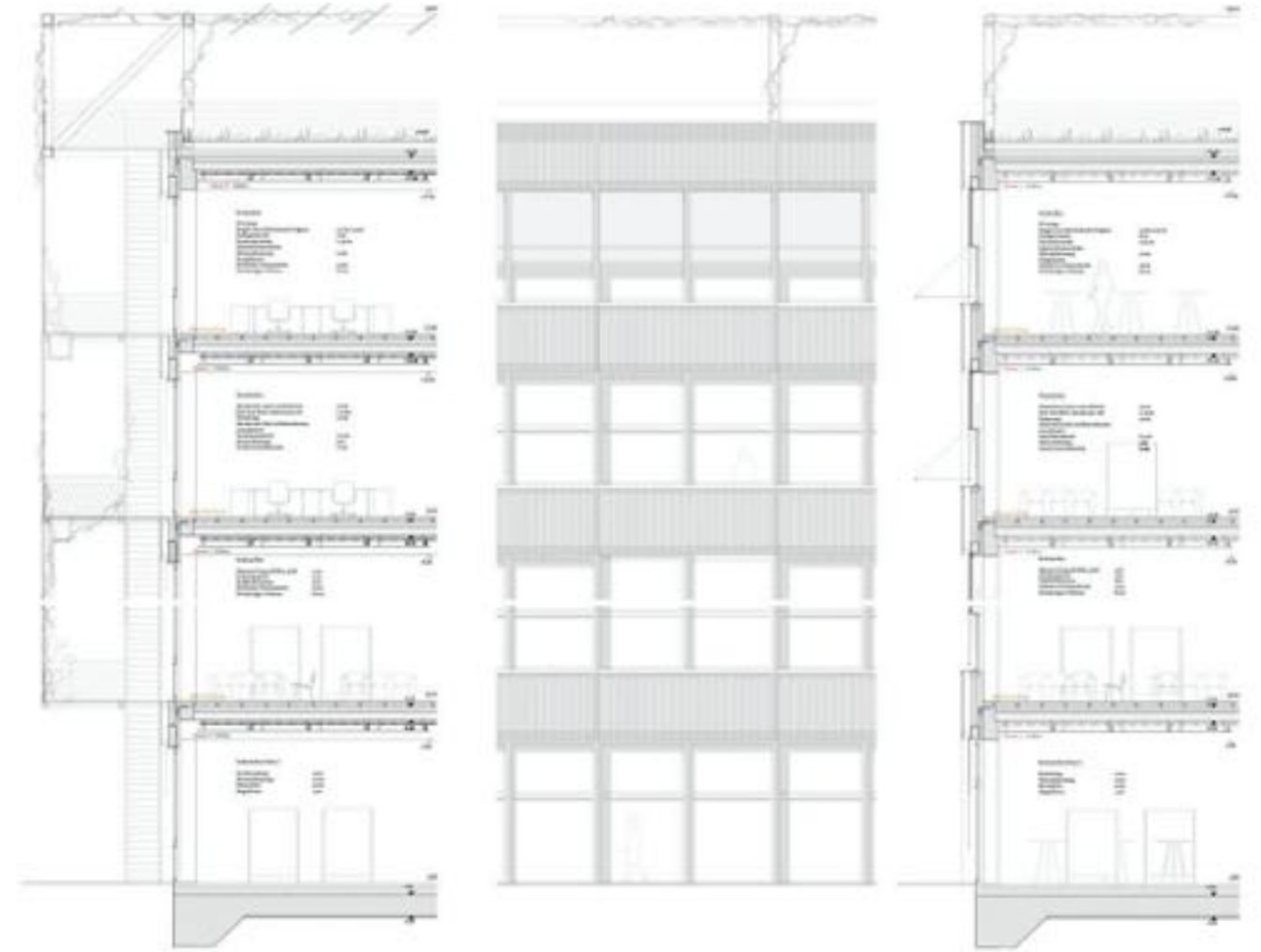
Konstruktionschnitt Südfassade, Fassadenausschnitt Westfassade und Konstruktionschnitt Westfassade
